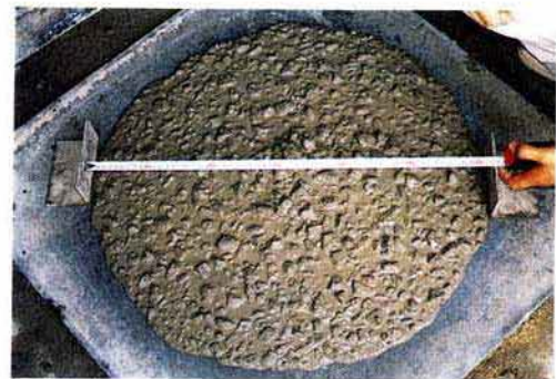
SFコンクリートの流動状況
