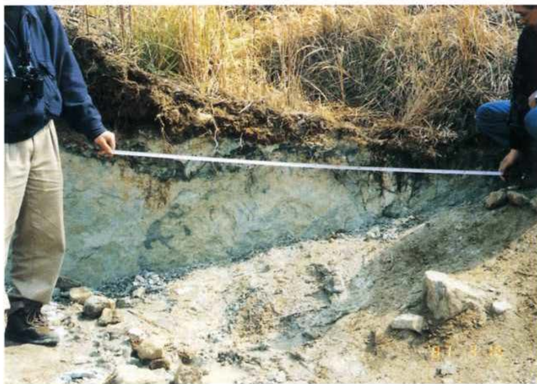
写真2 野島断層（水平移動 1.8m）
