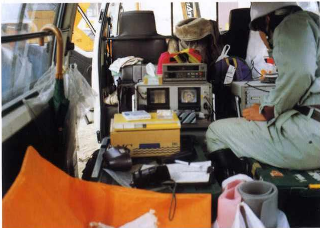
写真30 全周撮影型ボアホールテレビカメラを使用した基礎杭内部損傷評価例
