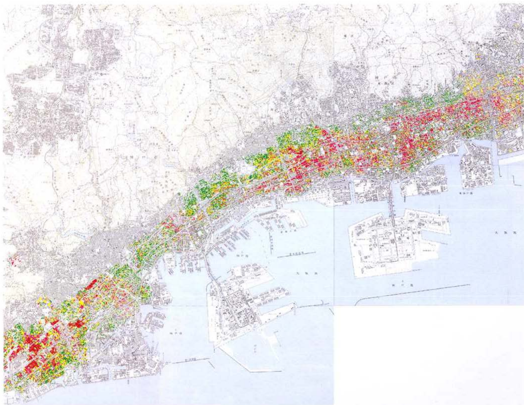
写真11 建築物震災マップ（その3）（芦屋市・神戸市東灘区・灘区・中央区・兵庫区・長田区）
