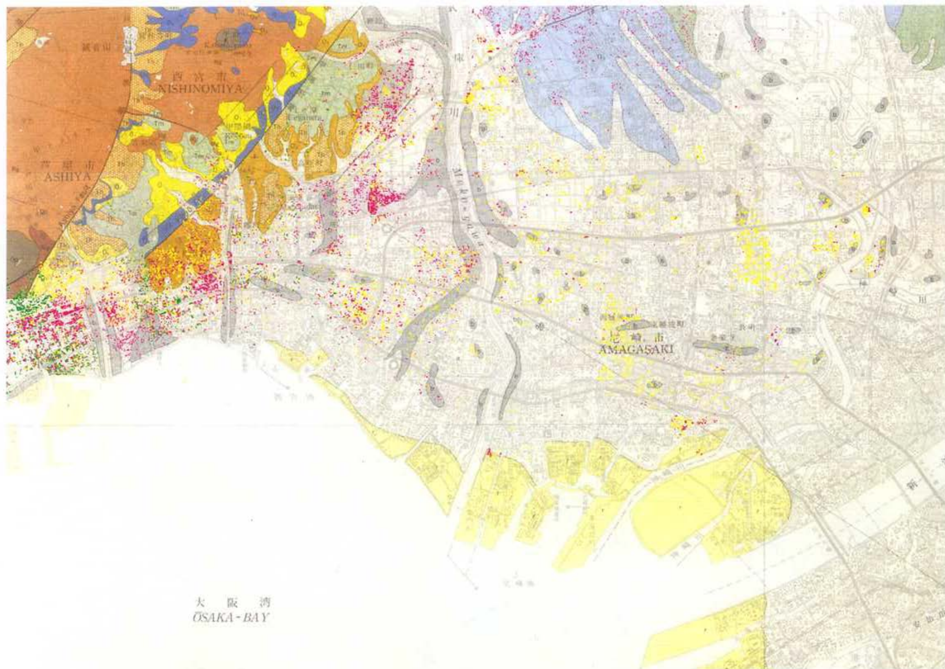
写真16 地質図の上にオーバーレイした建築物被害分布（その2）（尼崎市・西宮市・芦屋市・神戸市東灘区）
