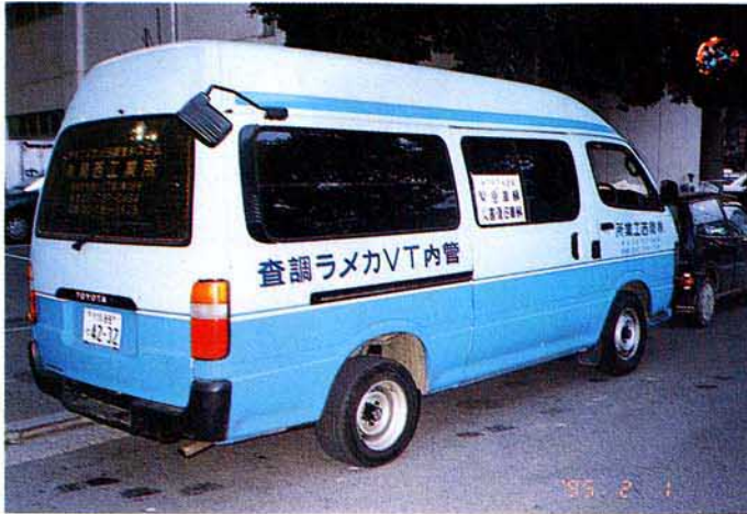
写真-19 下水管調査用TVシステム運搬車
