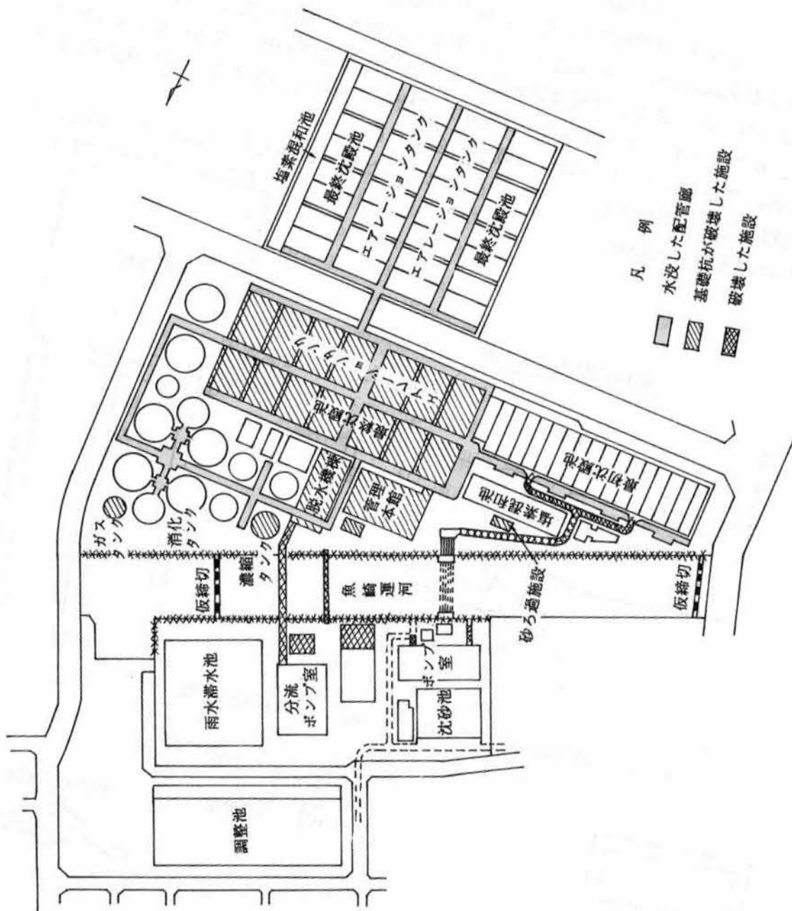
図-5 東灘処理場の被害状況
