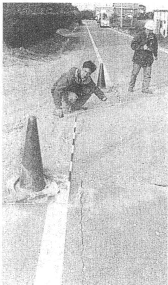
横にずれた野島断層を調べる通産省地質調査所の調査官ら。この地点では、直線の町道が山側（手前）と海側側で一・一メートルずれた。津名郡北淡町で
