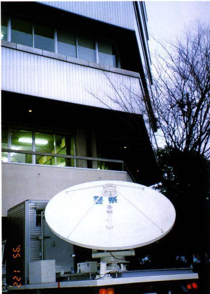
▲災害警備本部に設置された衛星通信車
