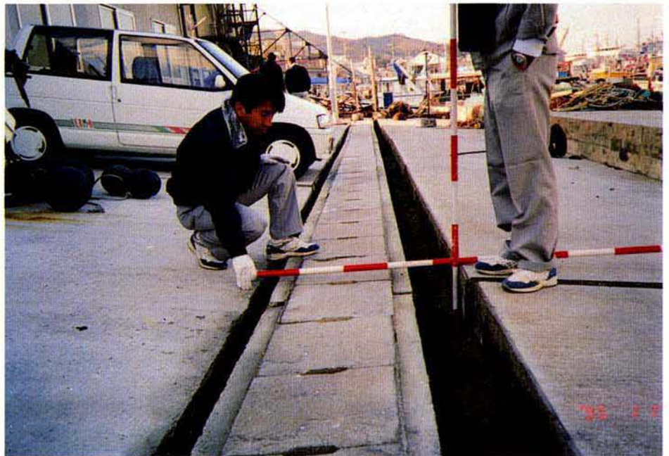
水叩きと側溝との間の開き 30 cm
