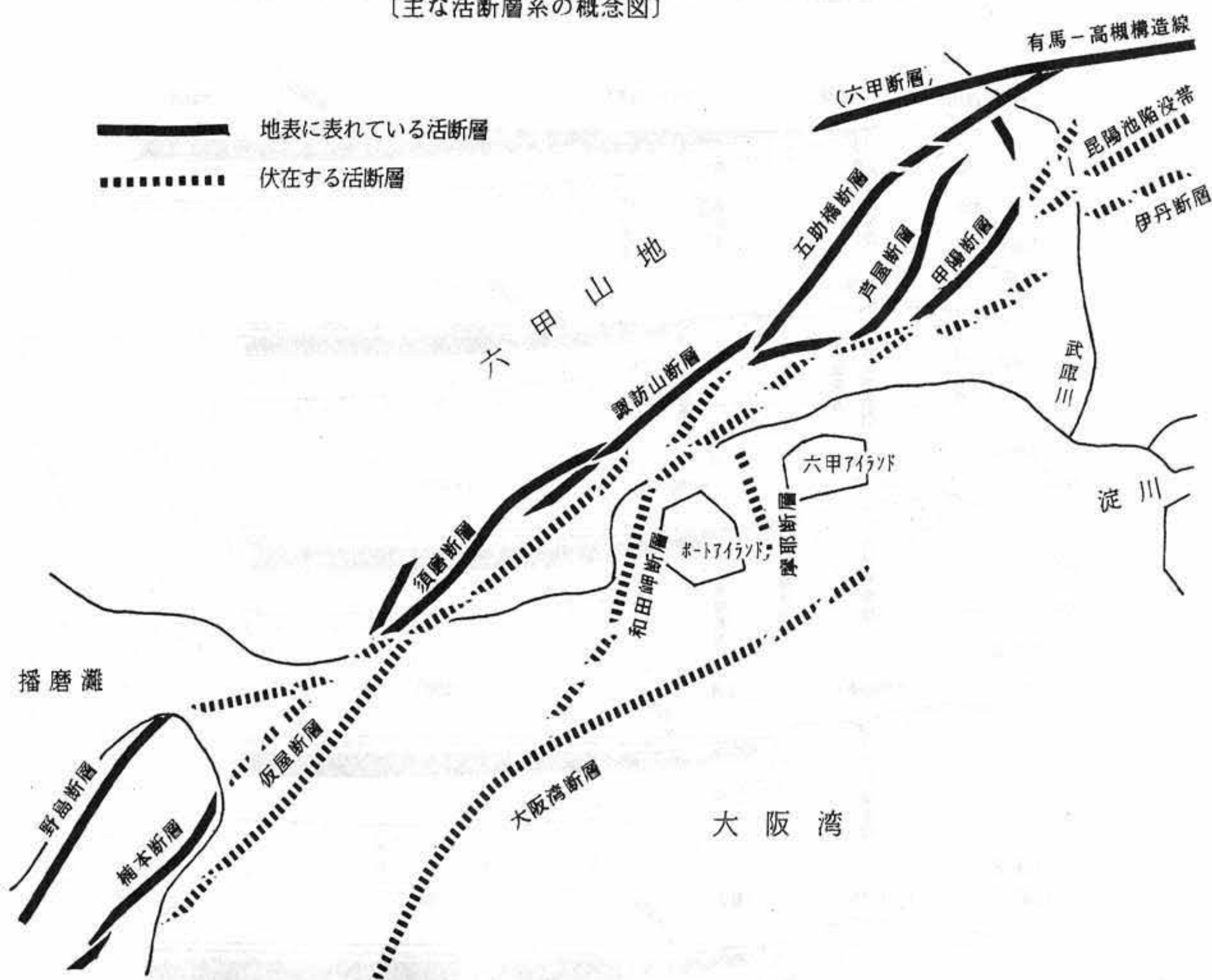
図-7. 伊丹台地西端～明石海峡にかけての神戸・阪神地域地質横断図と主な活断層系の概念図（阪神地域活断層調査委員会、1996）
