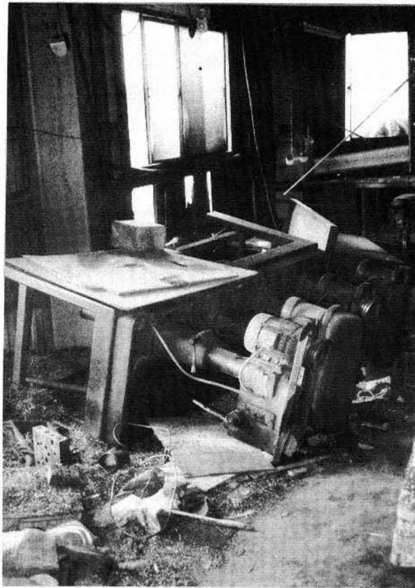
図6.2-8 転倒した工作機械 (神戸市灘区)
