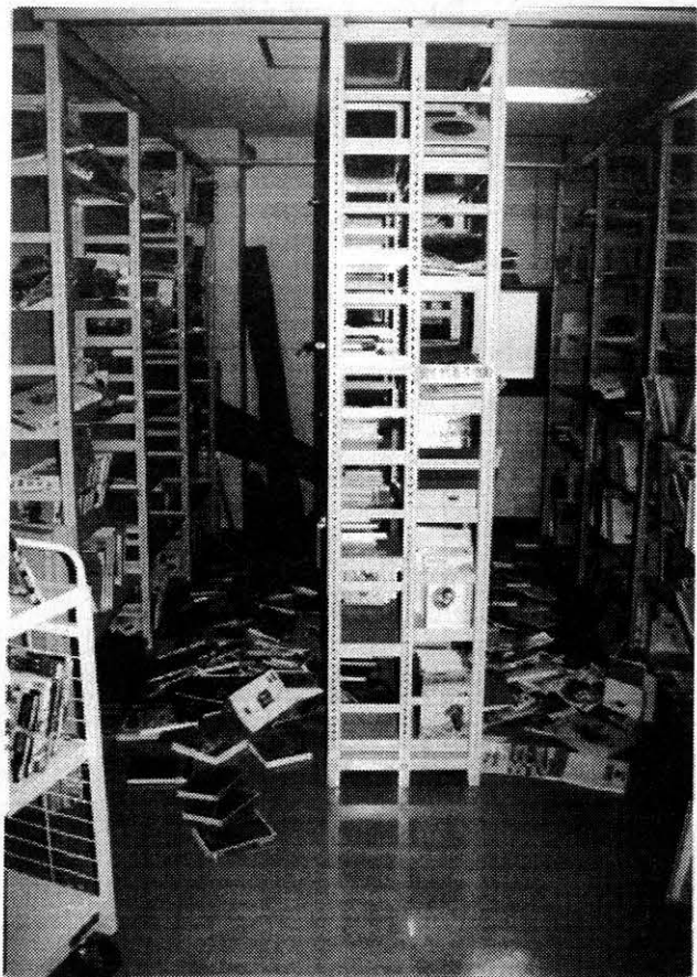
△写真(2) 移動図書館用スチール書架 書架は倒れていなかったが配架し ていた図書が落下し、散乱していた。
