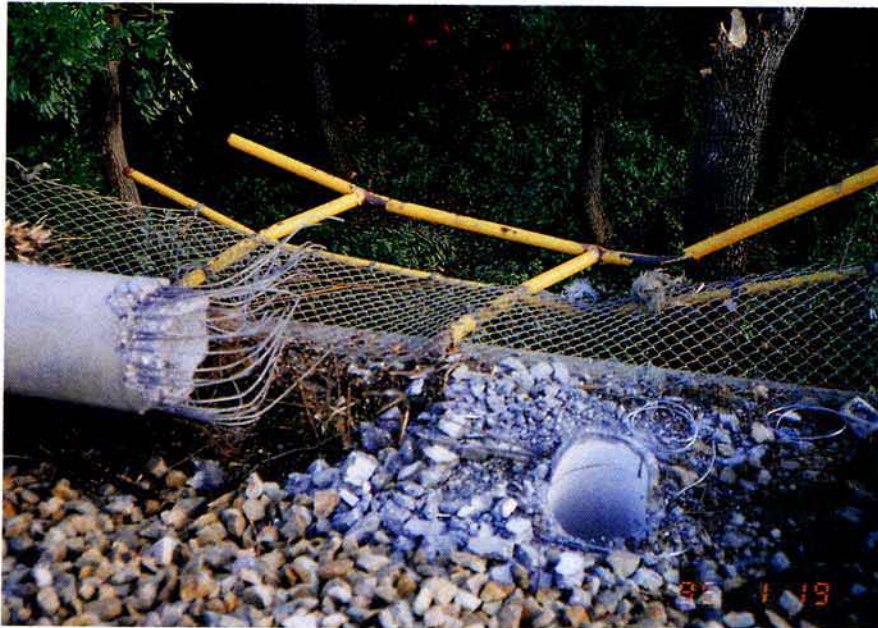
福知山線 中山寺駅構内 下り線 14k791m付近 電柱基礎部折損 (コン柱12N6.5) 基礎部が土留め擁壁と矢板の間であったため、地際部分が が硬点となり電柱が地際部で折損した。
