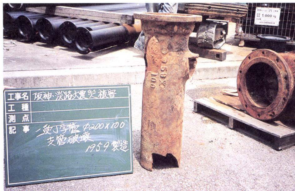
φ 200mm×100mm=受 T字管支管破壊 (1959年製造)
