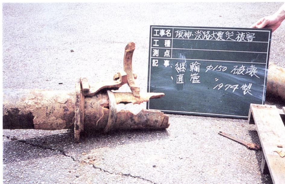
φ 150mm 継ぎ輪破壊 (1974年製造)
