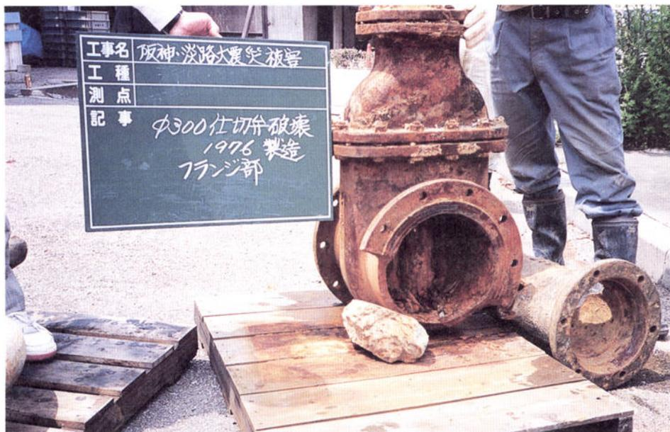
φ 300mm 仕切弁、フランジ部破壊 (1976年製造)
