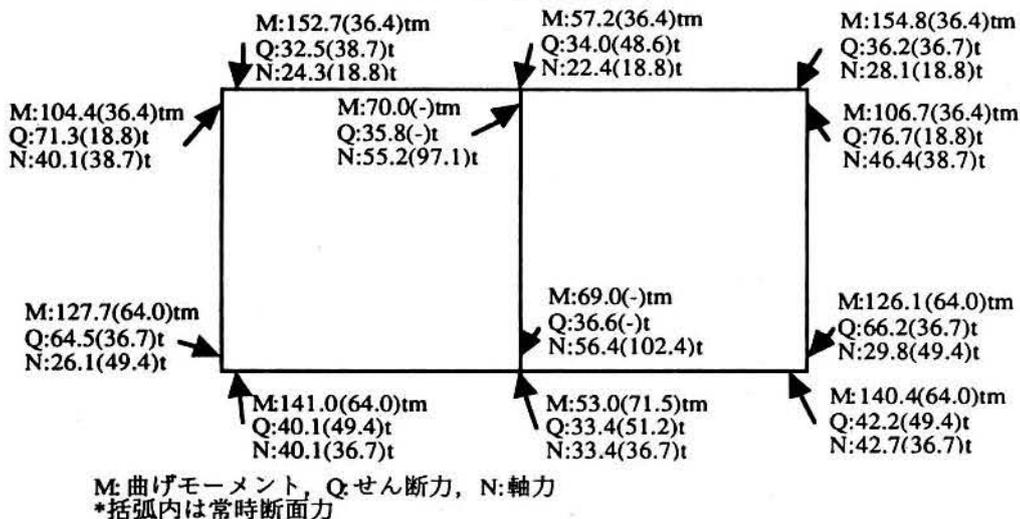
図-26 部材端最大断面力
