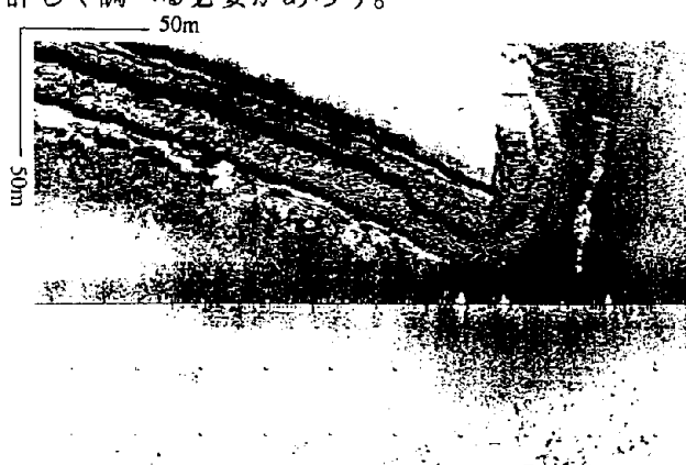
1図 防波堤の基部に認められる海底での液状化
