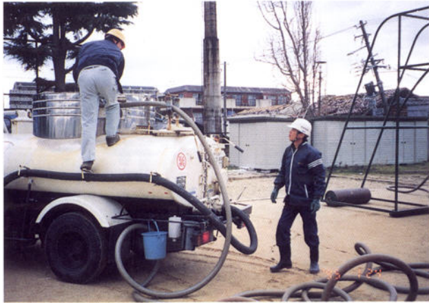
仮設トイレからのし尿収集作業 (提供：静岡県環境整備事業協同組合)
