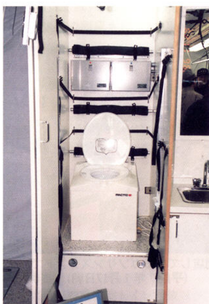
災害現地支援車内のトイレ
