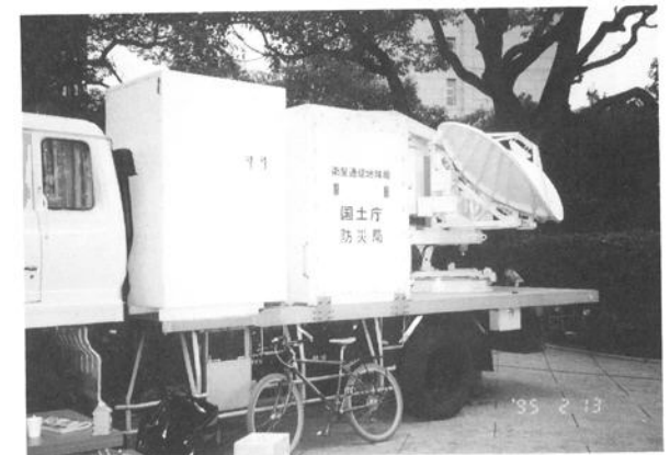
衛星通信地球局（国土庁防災局）（兵庫県公館）
