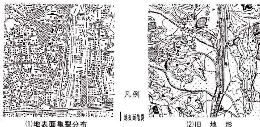
図2.3.6 夙川沿いの地表面亀裂の分布と旧地形 S=1:25,000
