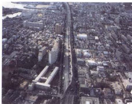
写真-Ⅱ.2.26 635mにわたるピルツ橋の倒壊
