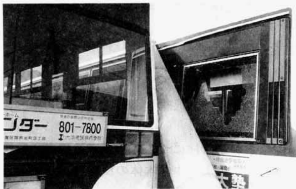
電柱の倒壊による車体損傷
