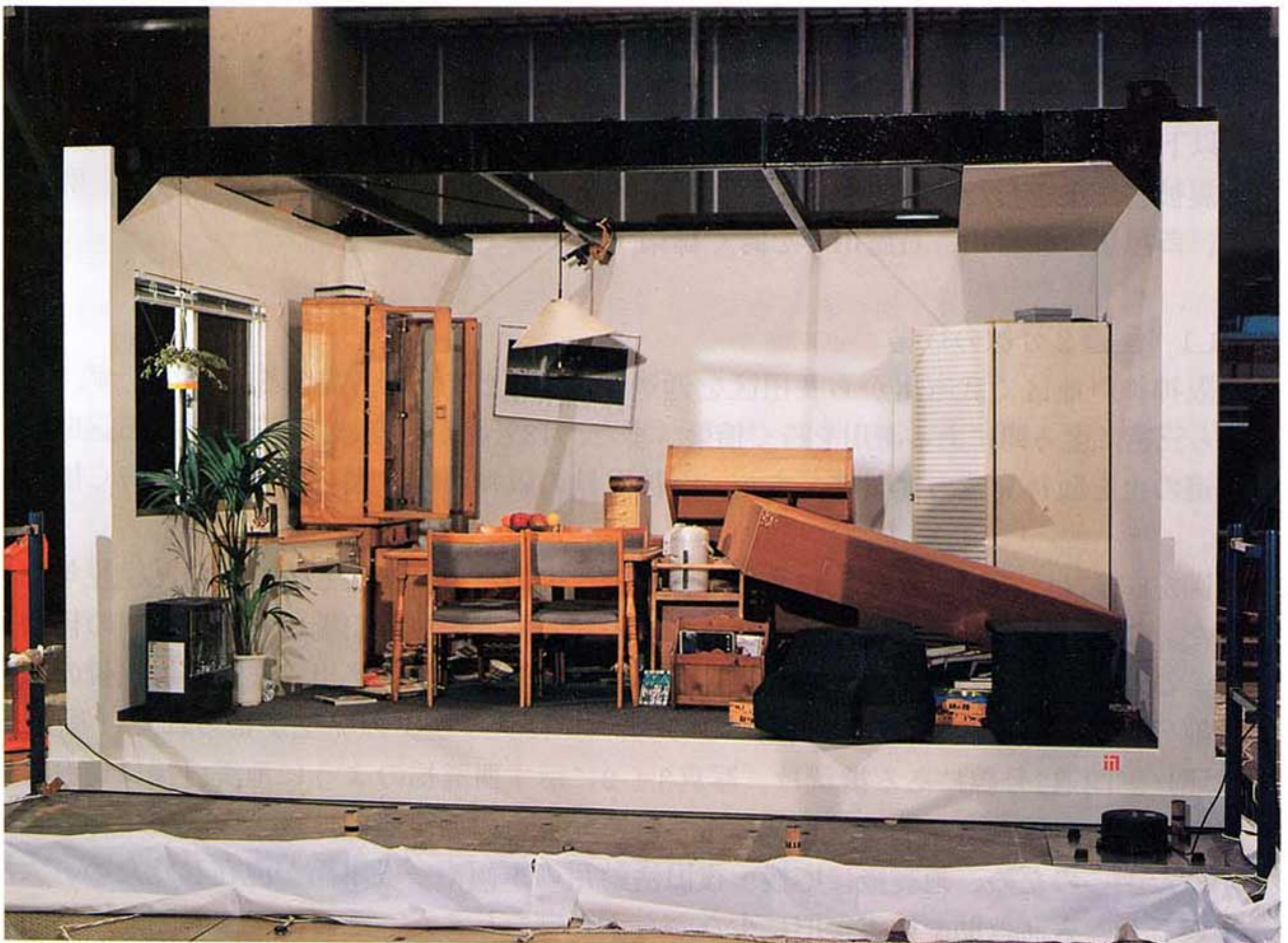
写真 2.3-2 試験後の部屋の状況（家具非固定）
