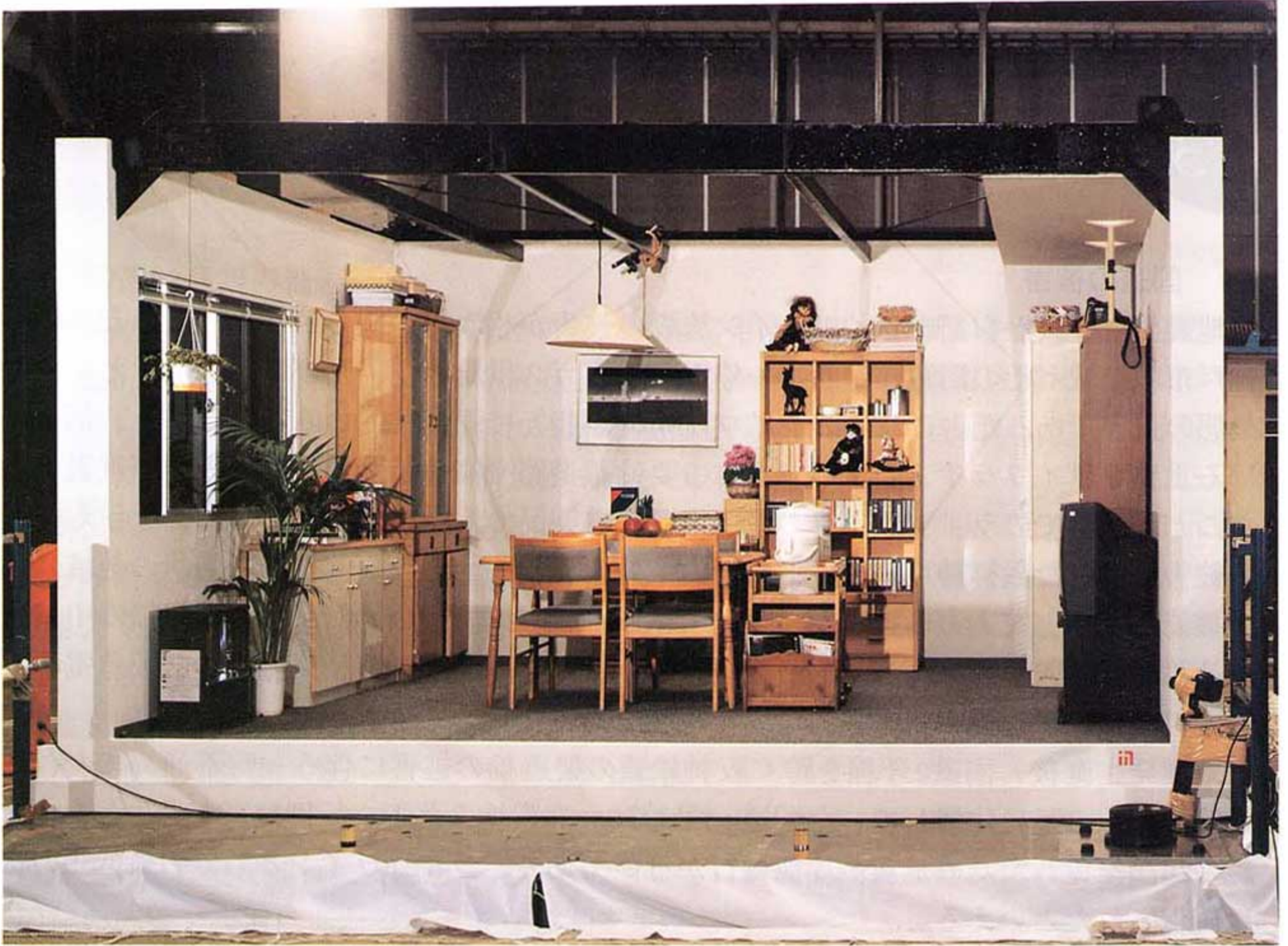
写真 2.3-1 試験前の部屋の状況（家具固定）
