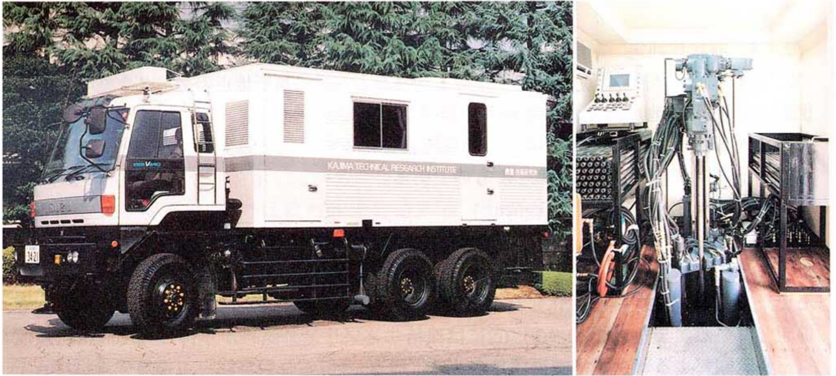
写真2.1-1 地盤調査車（左：全景、右：貫入装置）
