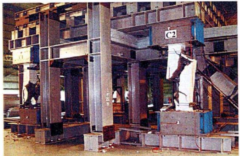
写真 4.4.12 帯筋間隔 40cm の柱の破壊状況
