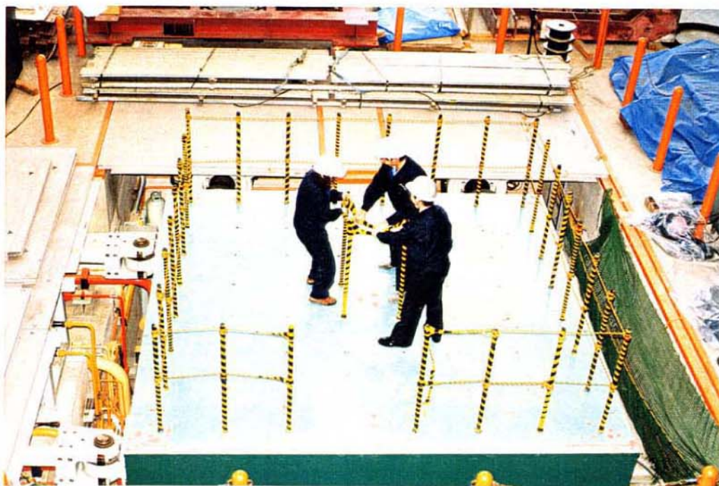
写真4.5.2 神戸海洋気象台で観測された地震記録の再現および体感実験
