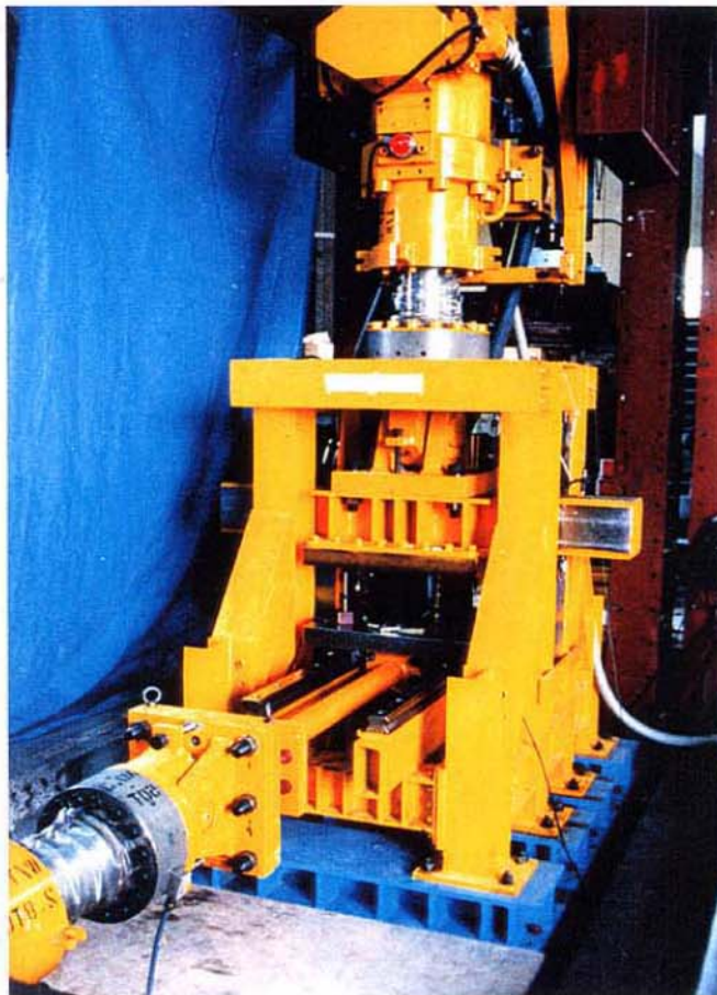
写真4.4.10 鉛プラグ入り積層ゴム 性能確認実験
