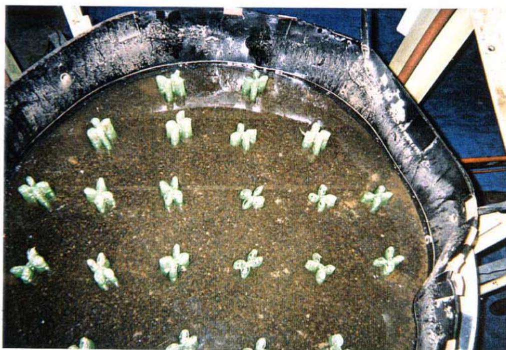
(b) クロスドレーン工法の模型実験
