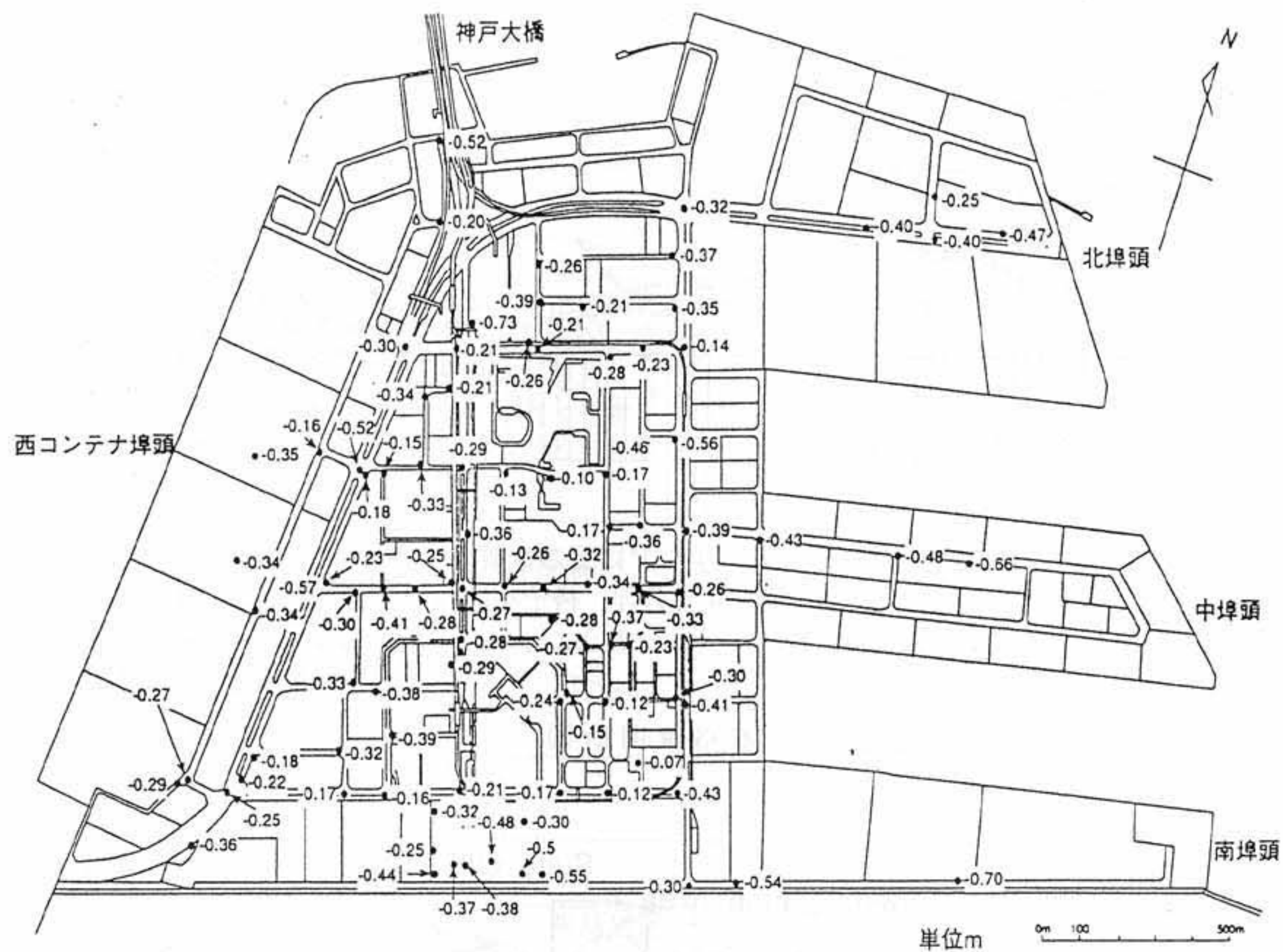
図4-3-1 地震による地盤沈下量の分布（ポートアイランド第1期） 29)
