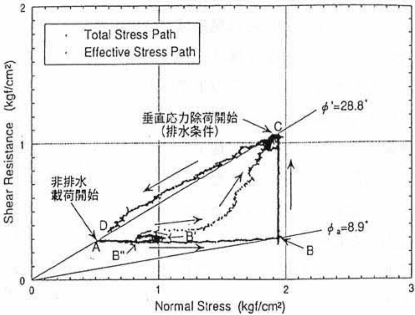
図17 非排水載荷リングせん断試験の結果 (福岡・佐々 33) 44) ).
