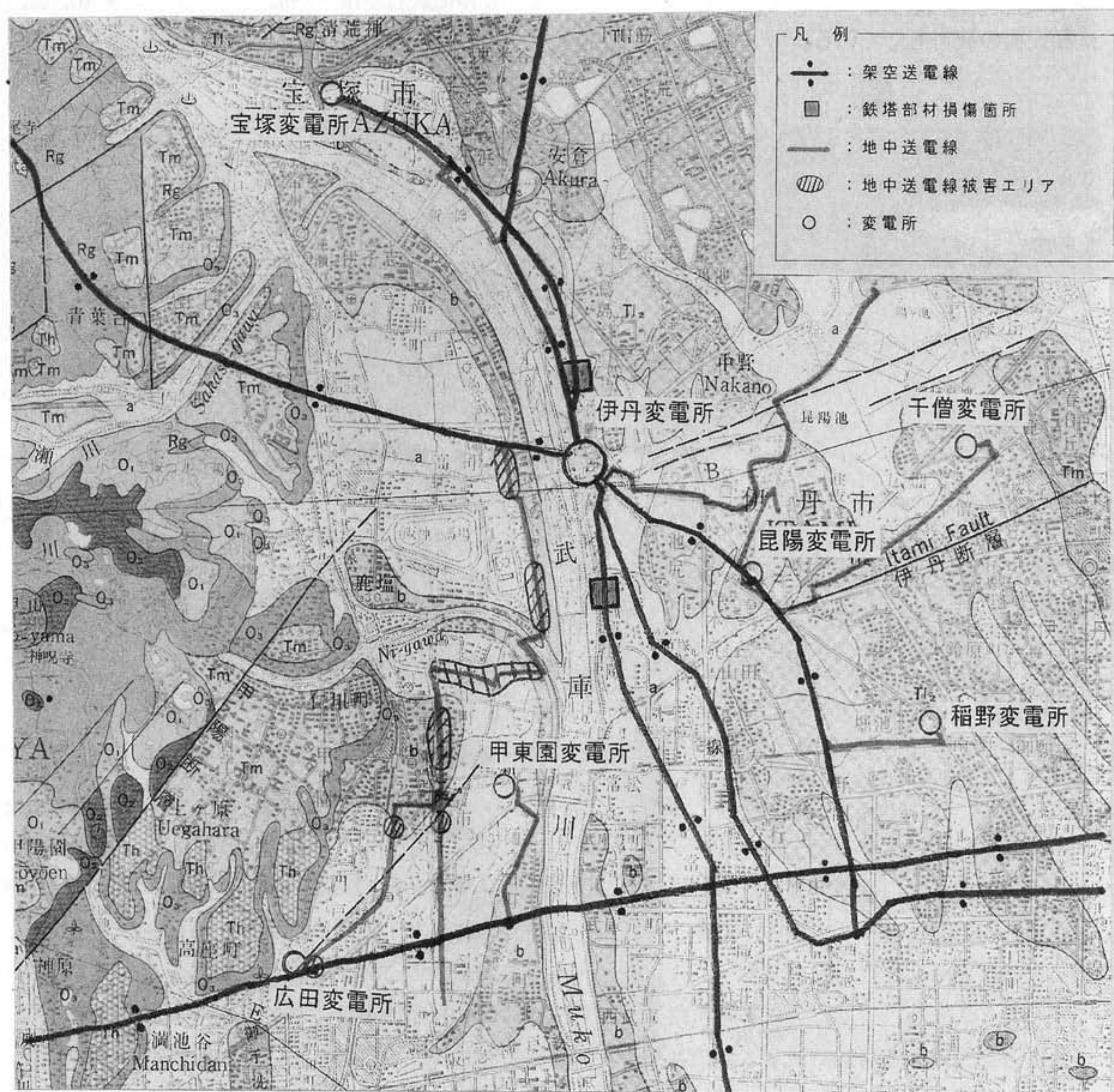
図8-5-8 甲陽断層東側における被害図 3) に加筆
