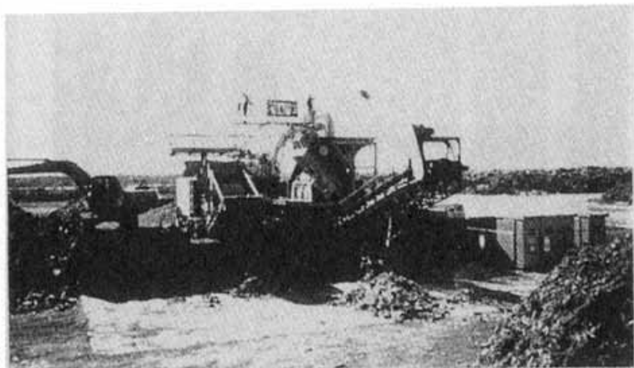
写真13.3.2.2 木材破砕機（ポートアイランド仮置き場）
