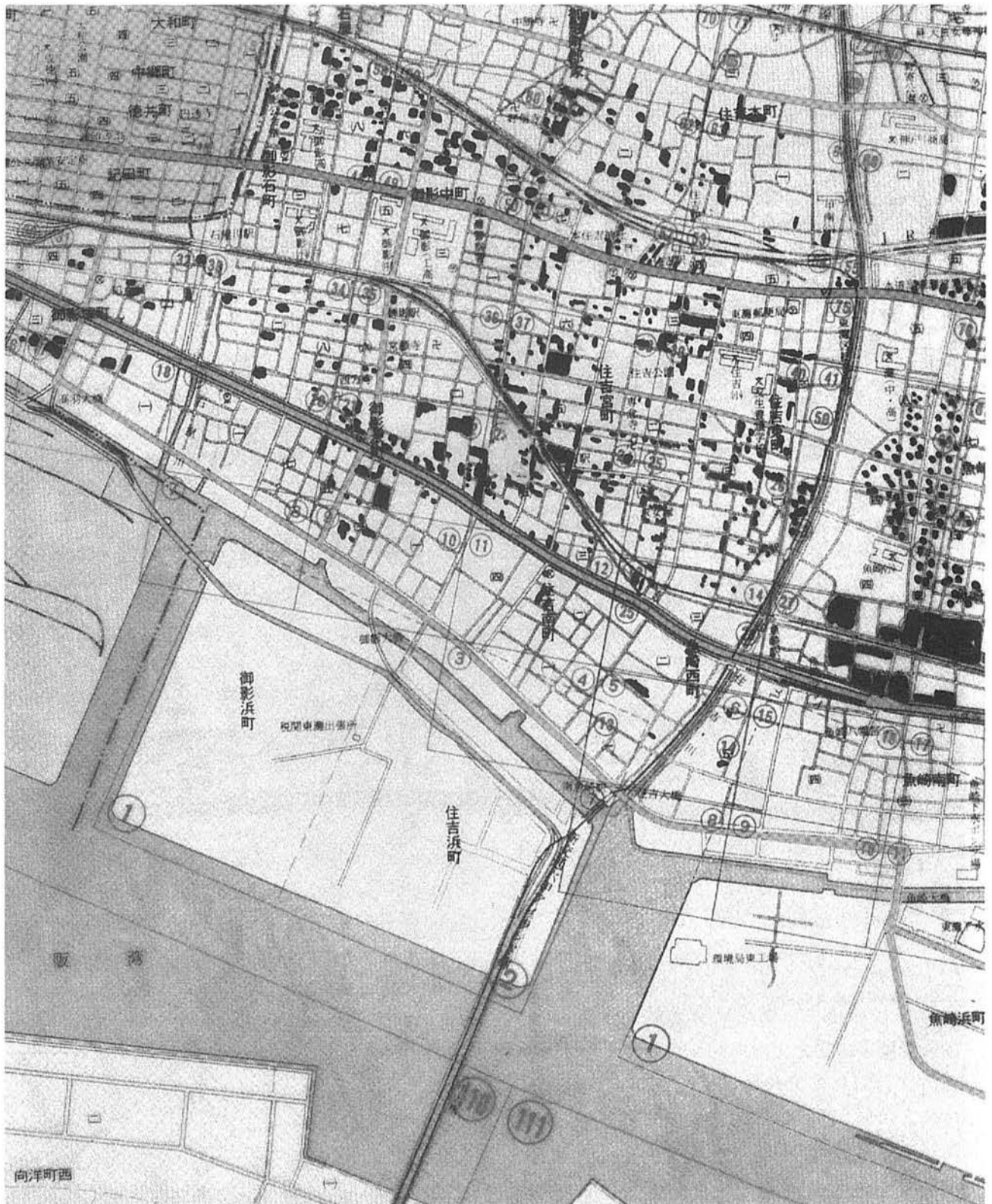
注) 塗りつぶしてあるところが大破 出典: 「1995年兵庫県南部地震災害調査速報」(株)日本建築学会
