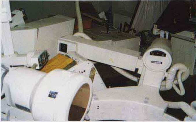
落下した脳血管造影撮影装置
