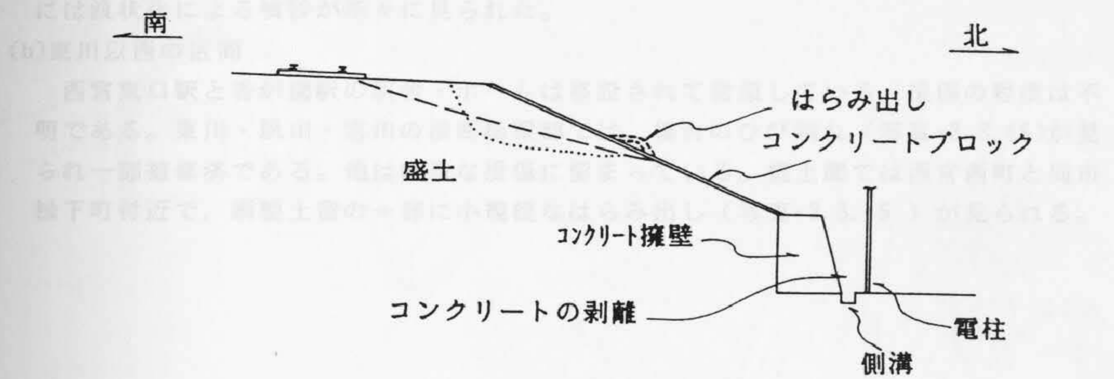
図-3.3.12 盛土の変状状況図
