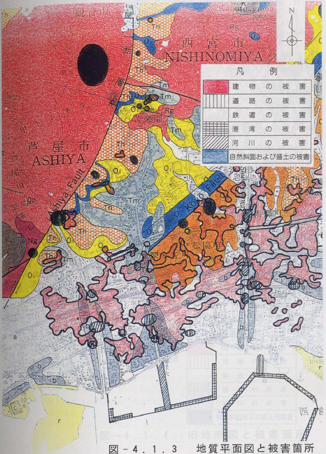
図 - 4 . 1 . 3 地質平面図と被害箇所
