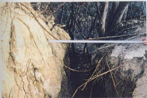
写真-6.4.12 写真-6.4.11の上部の状況(図-6.4.9の④) テンションクラックが多く見られ, 変状も大きい。
