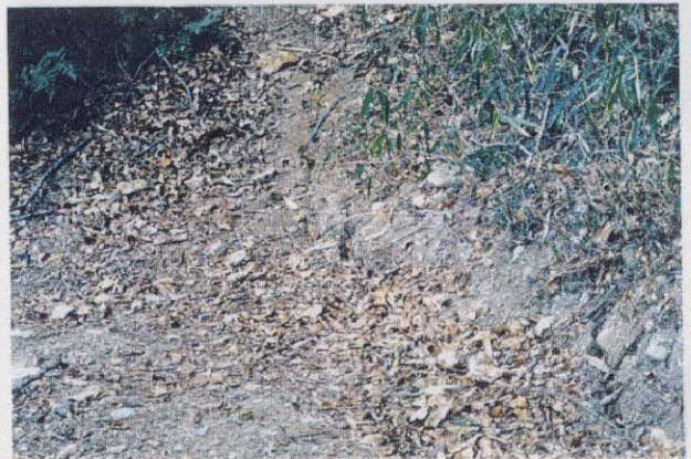
写真-6.4.15 篠原伯母野山の山中(図-6.4.9の⑦) 弱い地割れが見られる。谷側(左側)が10cm 程度沈下している。
