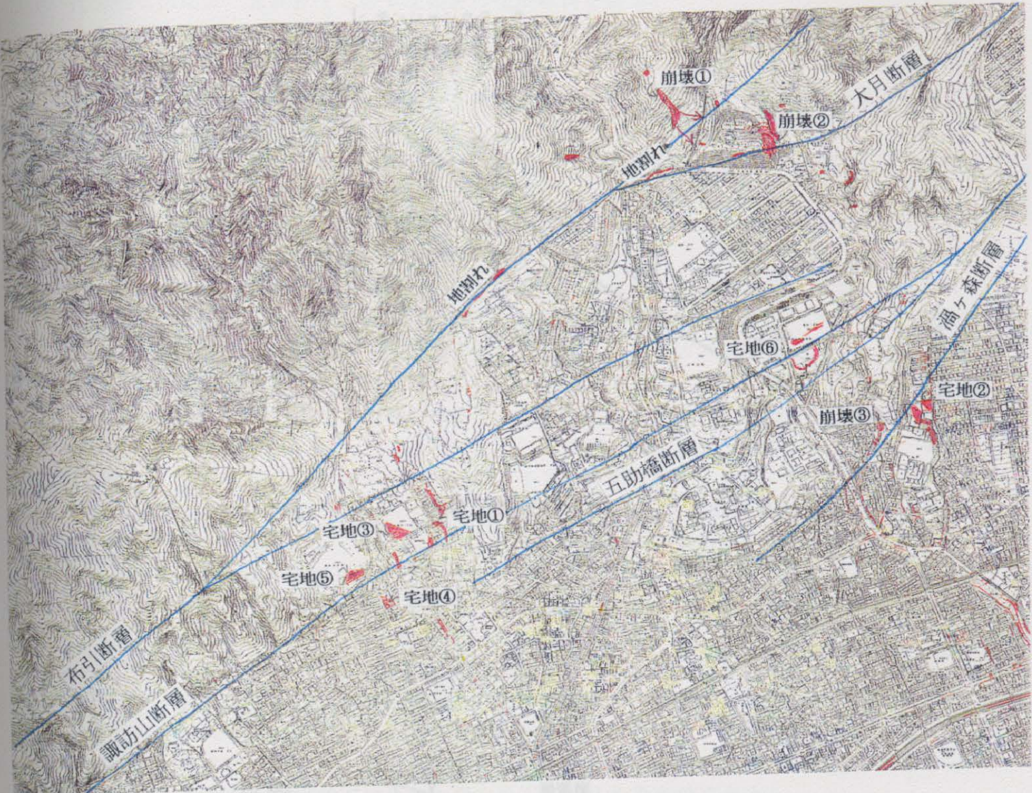
図-6.4.4 灘区山地部の被害状況 (S = 1 / 20,000) (断層の分布は文献2をもとに作図)
