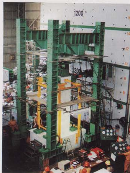
鋼管コンクリート複合柱の水平加力実験
