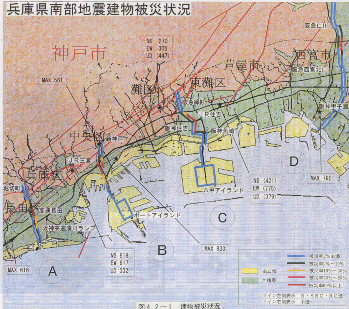
図4.2-1 建物被災状況
