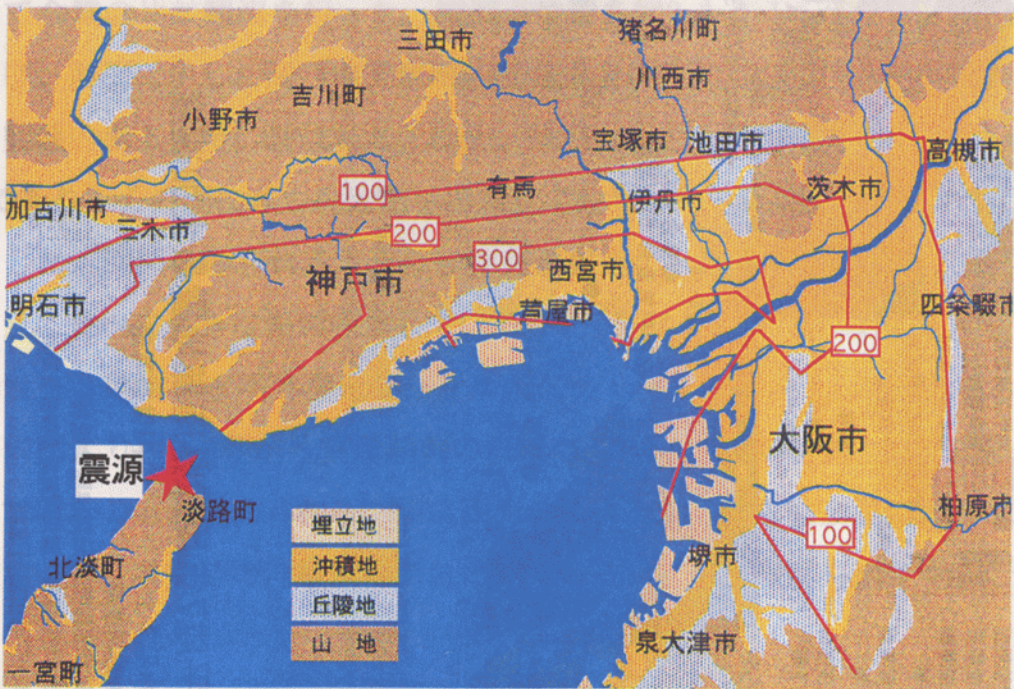
图3. 2. 1-3 最大上下加速度分布图 (Contour map of maximum vertical acceleration)
