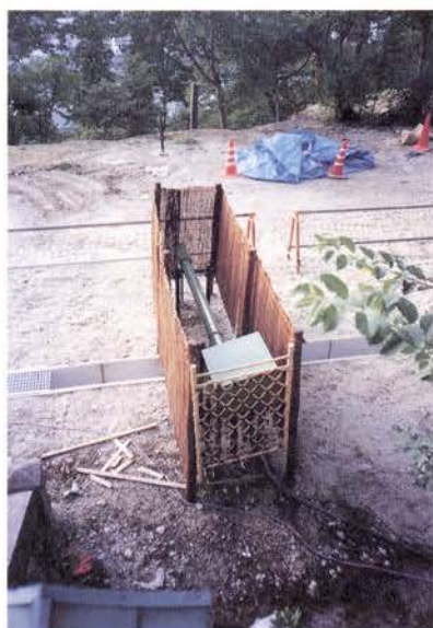
写真6 Aブロック頭部の伸縮計(AS1)
