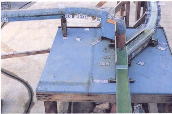
写真5 高倉川合流工水理模型実験
