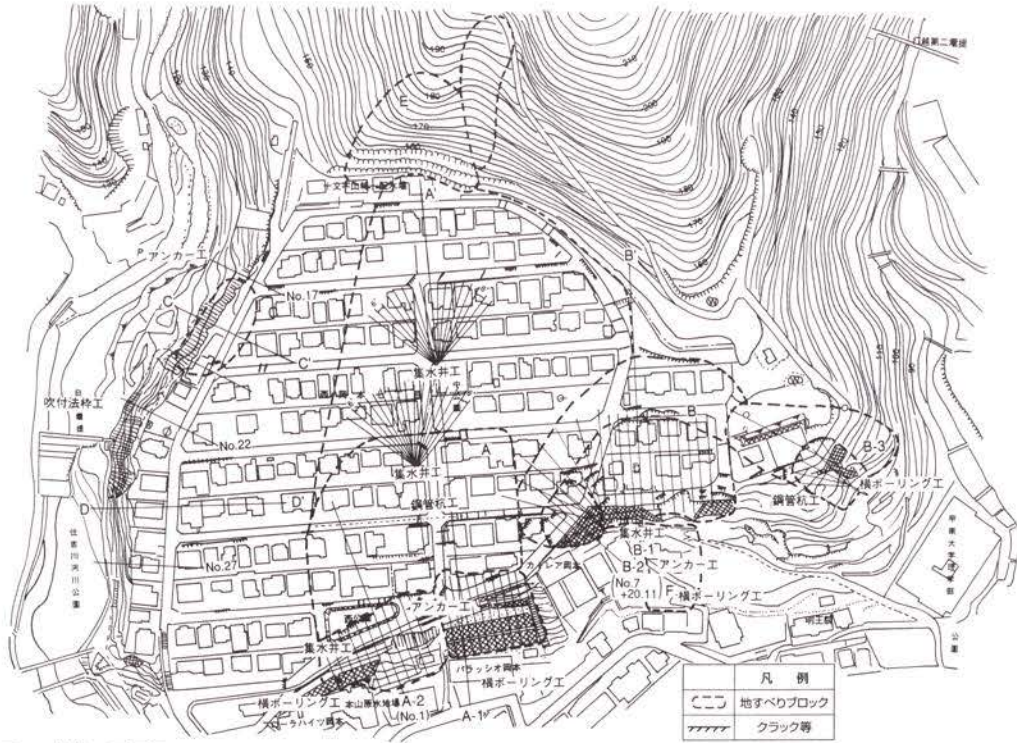
図6 対策工平面図
