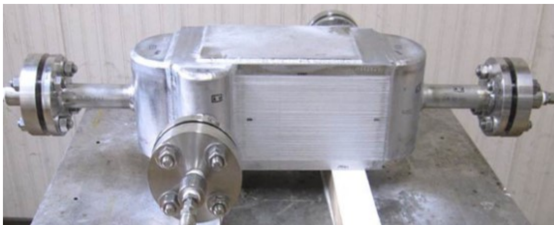
図 1-2(a) PCHE の外観写真[11]：幅×高さ×長さ: 200 mm × 200 mm × 400 mm, 設計熱交換量: 100 kW, エッチングプレートを 100 枚ほど積層
