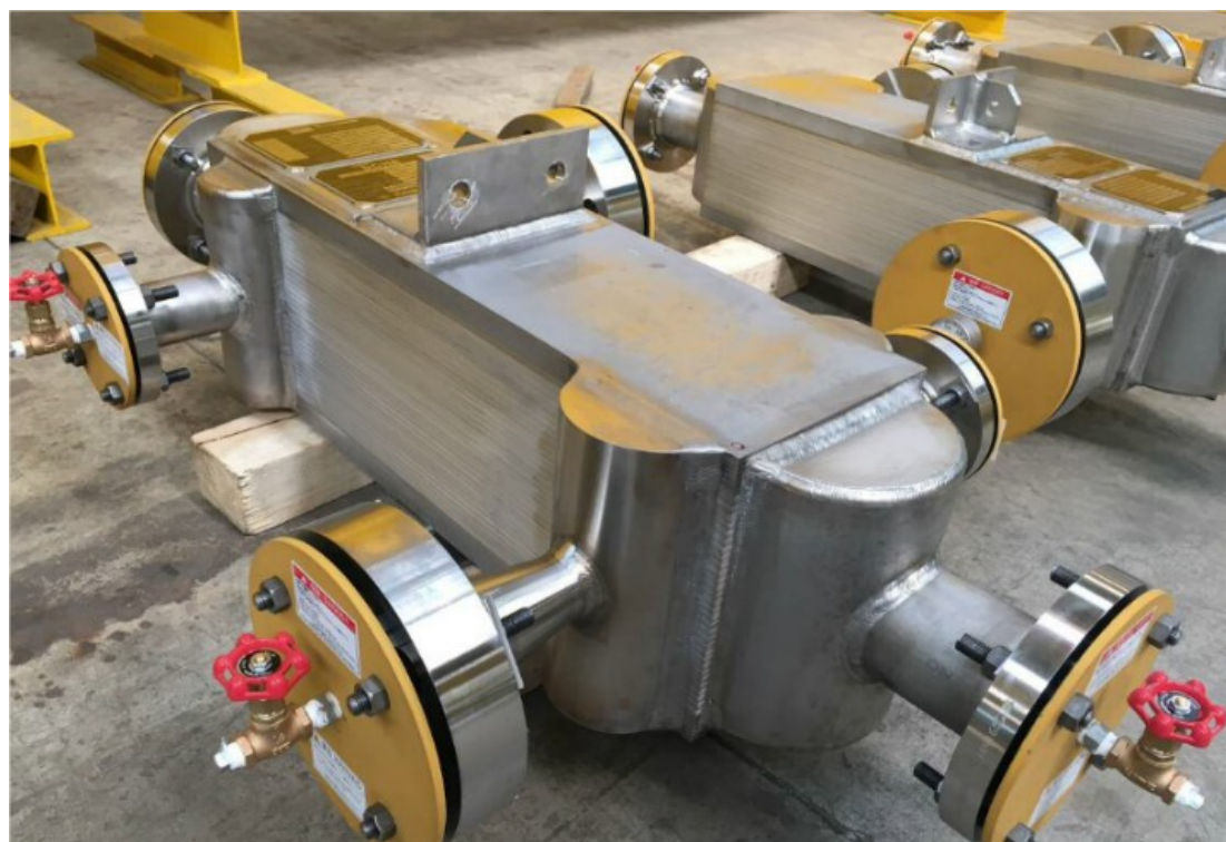
図 1-2(b) PCHE の外観写真: \text{LN}_2 気化器: 幅×高さ×長さ: 200 mm × 250 mm × 700 mm, 重量: 350 kg, 設計熱交換量: 310 kW
