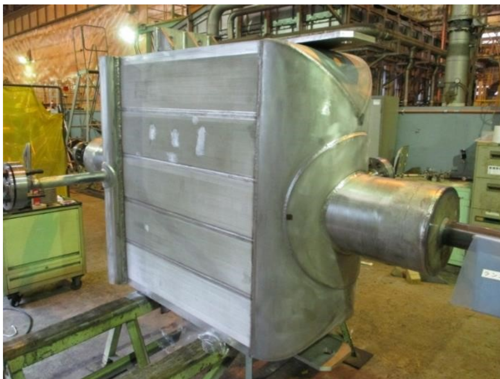
図 1-2(f) PCHE の外観写真: Boil off gas(BOG)再液化器: 幅×高さ×長さ: 580 mm × 1360 mm × 1200 mm, 重量: 6000 kg, 設計圧力: 32 MPa, 設計温度: -196℃ – +60℃
