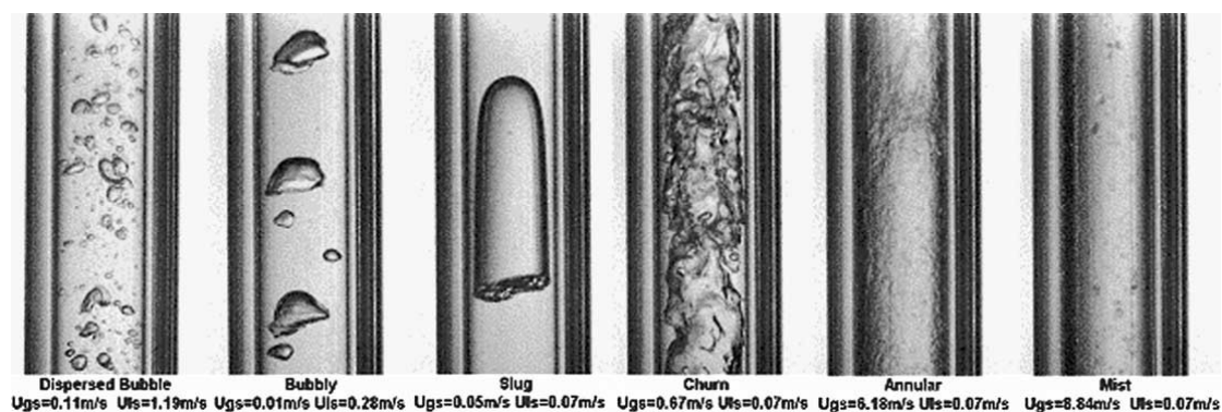
図 1-8 内径 4.26 mm の円管内垂直上昇流の沸騰二相流の流動様式可視化結果 ( Co = 0.18 ) [70]
