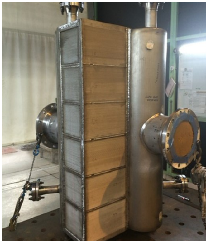
図 1-2(h) PCHE の外観写真: FPSO 向け熱交換器 ; 幅×高さ×長さ: 330 mm × 1520 mm × 750 mm, 重量: 3500 kg, 設計圧力: 22 MPa, 設計温度: -46°C – +177°C
