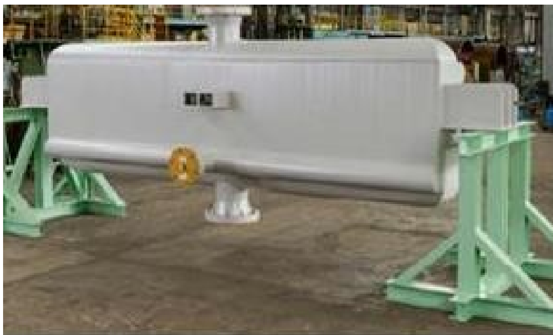
図 1-2(d) PCHE の外観写真: 天然ガス液回収ユニット向けガス/ガス熱交換器: 幅×高さ×長さ: 580 mm × 5200 mm × 1200 mm, 重量: 22000 kg, 設計熱交換量: 5700 kW
