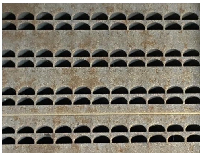
図 1-3(b) PCHE の流路断面
