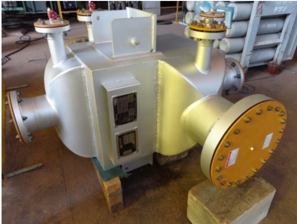
図 1-2(g) PCHE の外観写真: FPSO 向け熱交換器: 幅×高さ×長さ: 580 mm × 730 mm × 900 mm, 重量: 2700 kg
