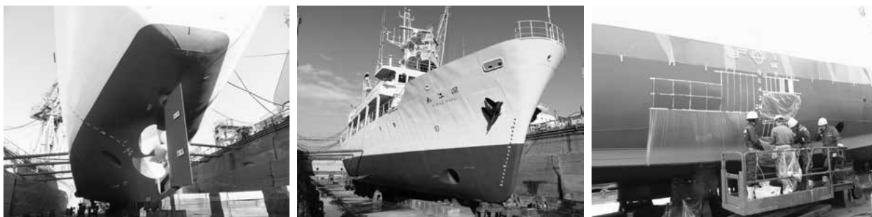
発展型船底防汚塗料の水線下全面への試験塗装と部分塗装
