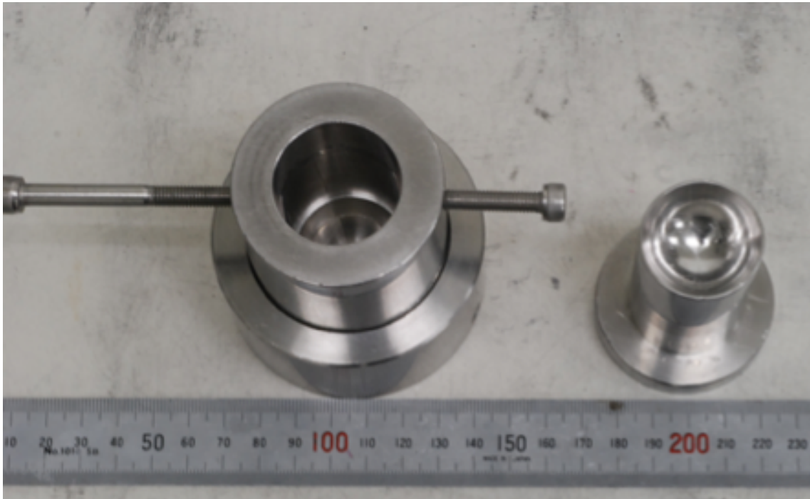
図 2-6 金属治具型（多孔質氷球作成用）の写真
