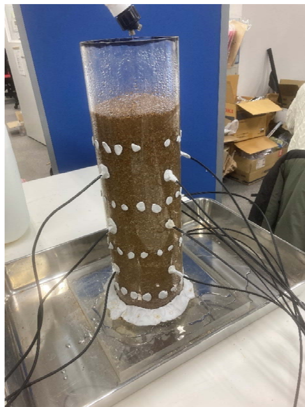
(b) パテによる止水状況
