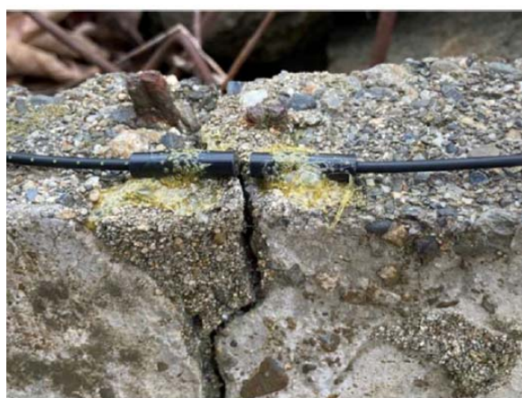
(a) ひび割れ部に設置した GAP センサー 24)
