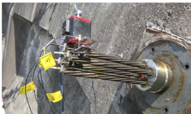
(a) 余長部に設置されたパイブレータと加速度計
