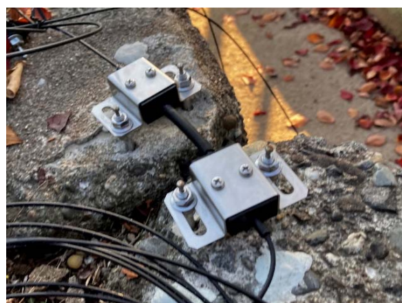
(b) 遮光処理をした GAP センサー
