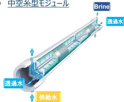
図 1-7. 平膜 (a)、中空糸膜 (b)、平膜 (スパイラル) 型モジュール (c)、中空糸型モジュール (d)のそれぞれの構造図 [29-31]。
