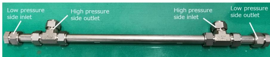
図 3-2. 実験室スケールの膜モジュールの写真。
