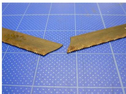
図 1-1 破損した弓鋸の刃
