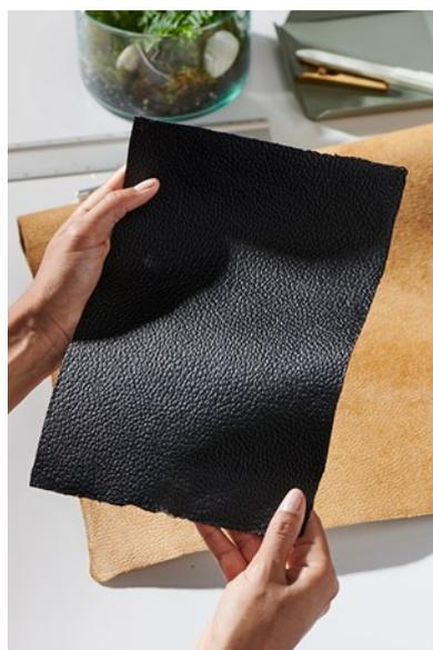
図 4-25 Bolt Threads の菌糸体素材 Mylo 出典<sup>63</sup>
