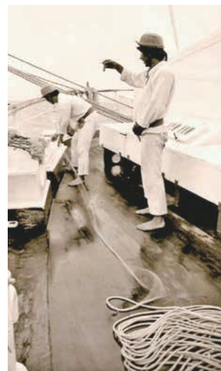
図4 ハンドログによる速力計測 (ログラインはスネークダウン)
