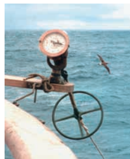
図2 海王丸の左舷船尾から曳航するパテントログと曳航測程儀の構成
