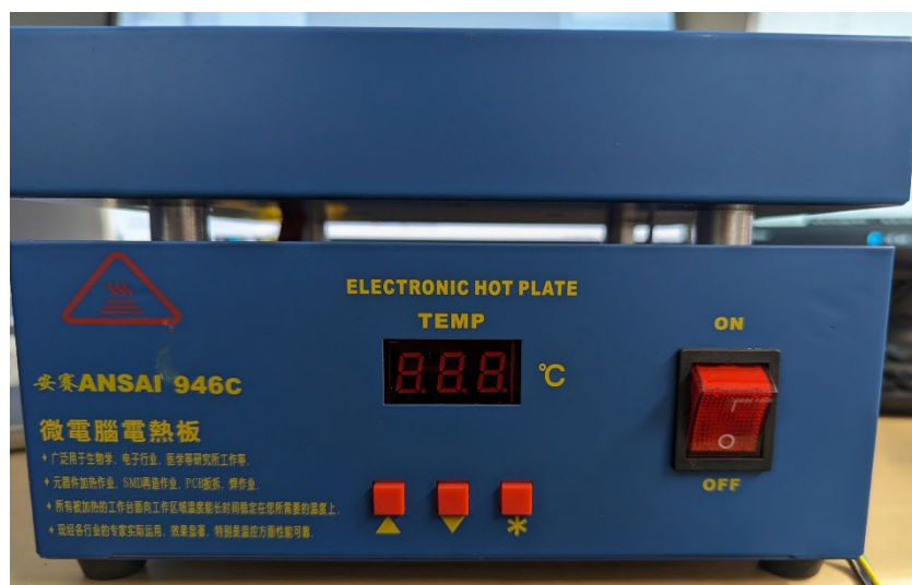
図 3.3: 使用したホットプレートの外観。中央にあるボタンで目標温度の設定を行う。現在の温度や目標温度は 7 セグメント LED に表示される。
