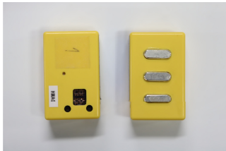
図 3 筋電位センサ Fig. 3 Myoelectric sensors.
