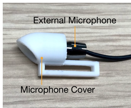
図8 外付けマイクのカバー Fig. 8 Implemented cover of external microphone.
