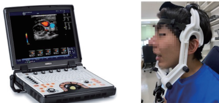
図2 実験風景の写真（左図：実験に使用した装置 LOGIQ e Premium（GE）、右図：ヘッドセットを装着した実験協力者。下顎にはプローブを当てている）
