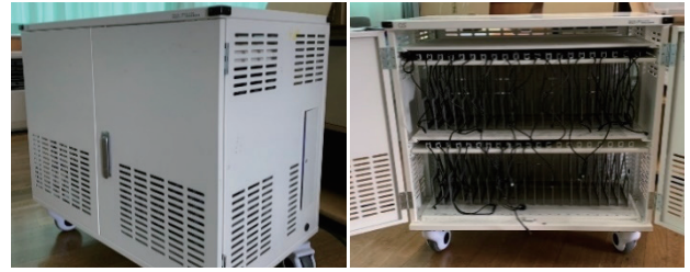
図1. コードの接続作業を終えたタブレット保管庫
