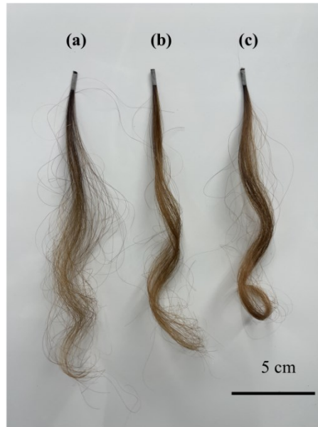
図 2-14 カールリテンション試験図 (a) Blank 処理 (b) グリオキシル酸処理 (c) ATS 処理
