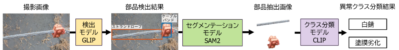
図1 大規模画像言語モデル(Vision-Language モデル)を用いた橋梁用ケーブル異常検出フロー
