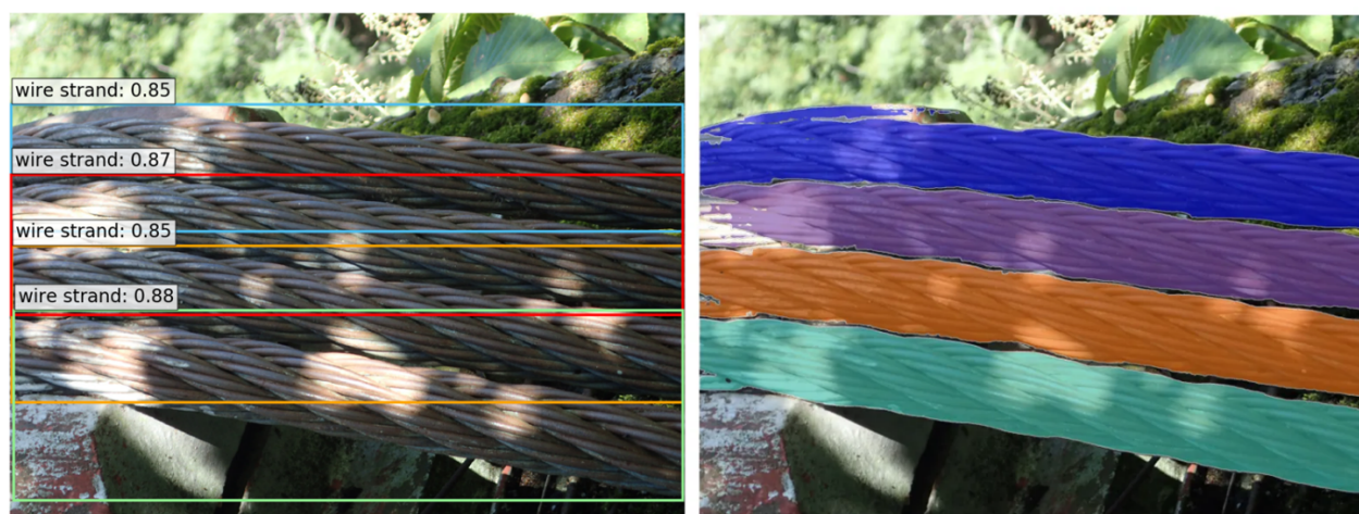
(a) 入力: GLIP によるストランドロープの検出結果 (b) 出力: バウンディングボックスごとのマスク
