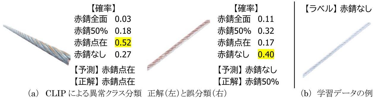
図 7 ファインチューニングを行った CLIP を用いた異常クラス分類の例とそのファインチューニングに用いた学習データの例
